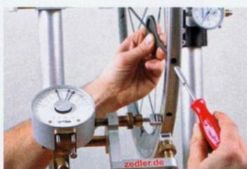
**3** Bei einigen Systemlaufrädern liegen die Nippel versteckt im Inneren der Felge. Hier muss der Reifen abgezogen werden, um die Nippel vom Felgenbett her mit einem Steckschlüssel zu erreichen. Das Zentrieren geht wie bei konventionellen Laufrädern, das Werkzeug wird im Uhrzeigersinn gedreht.
