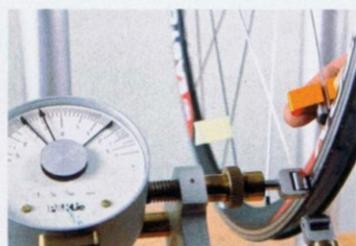
**2** Arbeiten Sie allmählich und in kleinen Schritten sowie an allen Seitenschlägen gleichmäßig, um das Laufrad in die Mitte zu bekommen. Spannen Sie die Speichen, bis Felge oder Zeiger maximal ein bis zwei Zehntel Millimeter zu jeder Seite ausschlagen.
