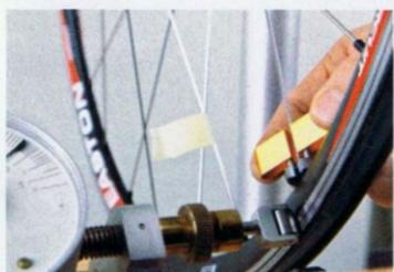
**1** Wo die Felge am nächsten zum Zeiger steht, müssen Sie die Speiche der gegenüberliegenden Seite nachspannen. Drehen Sie maximal eine halbe Umdrehung. Die Speichen (derselben Seite) davor und dahinter werden auch eine Viertel Umdrehung nachgespannt.
