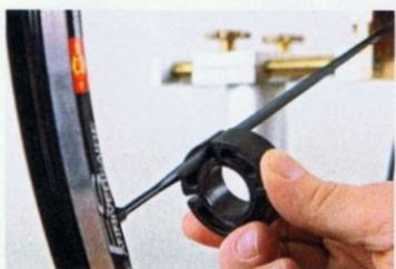
**1** Aerodynamisch geformte Messerspeichen sollten beim Zentrieren strömungsgünstig ausgerichtet bleiben und nicht unnötig verdreht werden. Mit einem Zentrierkloben wie im Bild sichern Sie die Speichen.
