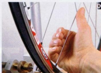
**3** Umfassen Sie die Speiche so, dass der Daumen zur Nabe zeigt: Die Fingerspitzen zeigen die Drehrichtung an. Der Daumen weist in die Richtung, in die sich der Nippel beim Drehen bewegt. Da er von der Felge festgehalten wird, zieht er die Speiche stramm.
