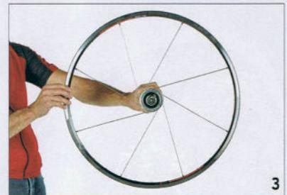
**3** Jetzt die Nabe so weit wie möglich gegen den Uhrzeigersinn in der Felge verdrehen. Damit erreicht man, dass die Speichen tangential an der Nabe anliegen, so wie sie im fertigen Laufrad liegen werden.
